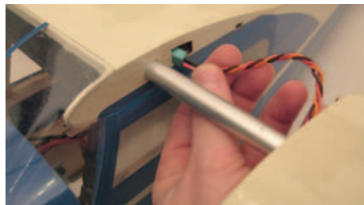
Die Flächenhälften werden seitlich gesteckt. Das Servokabel muss man durch die Flächenaufnahme fädeln
