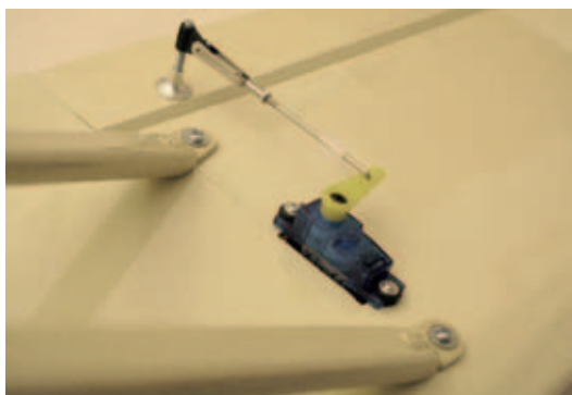
Simpel aber wenig dezent erfolgt der Querruderservoeinbau stehend
