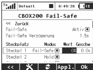
Fig. 16: Geräteübersicht - Fail Safe
