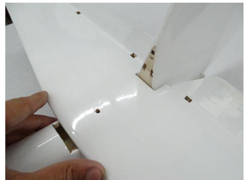
Wenn das Höhenruder an der passenden Stelle ist, verschrauben Sie die Höhenruderabdeckung mit dem Höhenruder und dem Rumpf mit Hilfe der beiliegenden M4 Schraube
