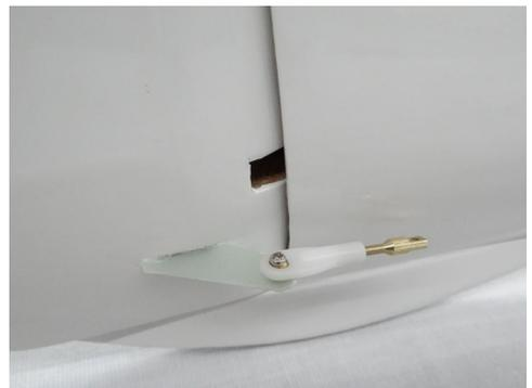
Das beiliegende Anlenkungsseil ist kunststoffummantelt und kann einfach mit dem Feuerzeug verschmolzen werden. Aus optischen Gründen können Sie noch einen Schrumpfschlauch über die verdrehte Stelle geben
