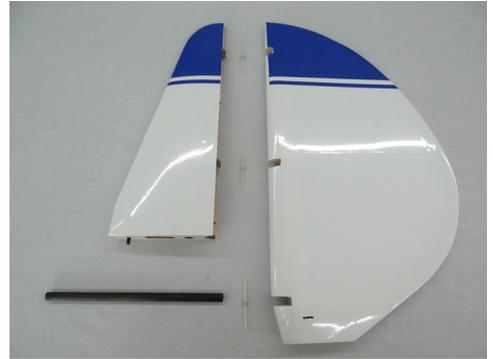
Beginnen Sie mit dem Einkleben der 3 Scharniere, diese zuvor noch einölen damit nichts verklebt und dann mit PU-Kleber einkleben. Darauf achten, dass sich die 3 Drehpunkte in einer Linie befinden
