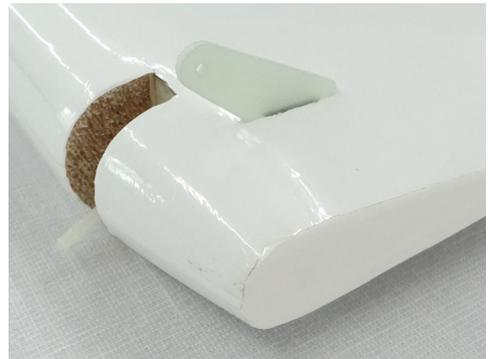
Kleben Sie nun das Seitenruderstockungsrohr in den Seitenruderdämpfer
