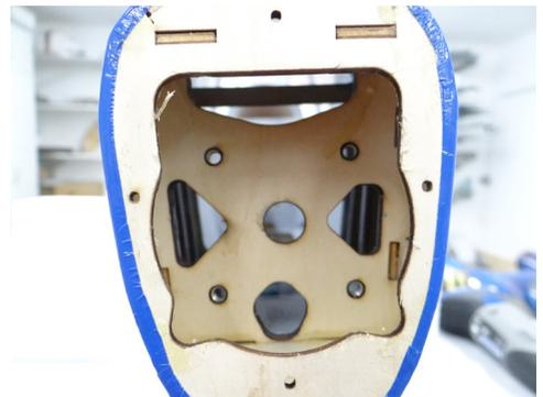
Montieren Sie den Motor mit Hilfe von 4 M4 Schrauben in den Rumpf, der Propellermitnehmer wurde zuvor noch gekürzt, damit dieser dann nicht zu weit aus dem Modell ragt
