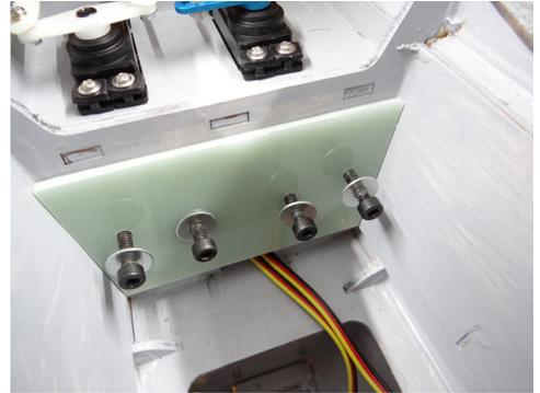
Wenn dies möglich ist, kleben Sie die GFK Platte in den Rumpf. Alle 4 Schrauben sollen während des Aushärten fest verschraubt sein
