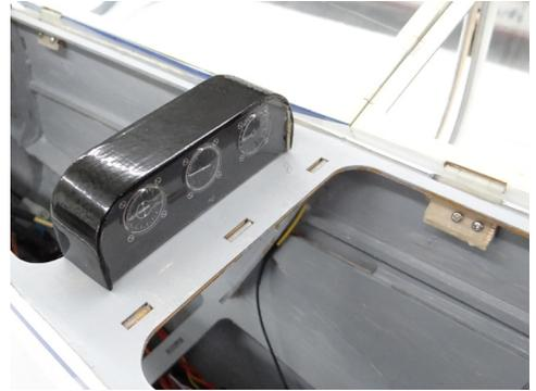
Der vordere Instrumentenpilz wird einfach mit zwei Schrauben verschraubt, um nachträglich noch leicht zu Motor und Regler zu gelangen. Die beiden Sitze werden einfach durch die bereits eingeklebten Magnete gehalten, dadurch ist ein einfacher Zugang zu Akku und Empfänger möglich
