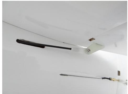
Kontrollieren Sie davor die Neutralstellung des Servos so wie des Ruders. Schrauben Sie nun das Höhenruder Servo (hier ein HITEC HS-7245MH) hinter das Seitenruder Servo unten in die Halterung, verbinden Sie den Kugelkopf mit der Schubstange und verschrauben diesen mit dem Servohebel.
