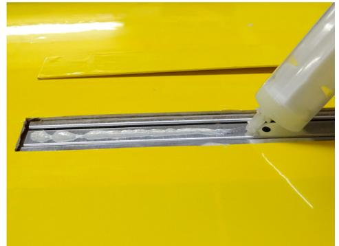
Während des Aushärtens, beschweren Sie die Abdeckung mit Gewichtern damit diese eine perfekte Linie mit dem Flügel bilden
