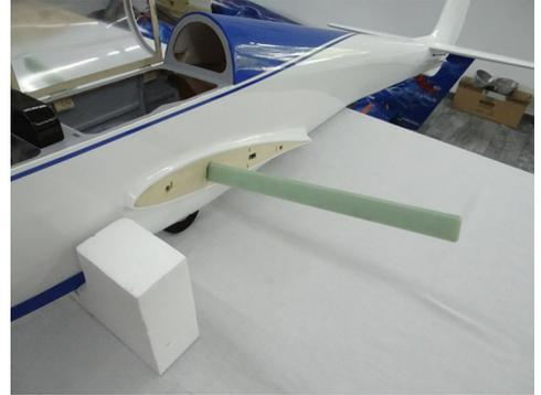
Versuchen Sie nun die beiden Flächen Probetalber an den Rumpf zu stecken um zu sehen, ob diese auch passen
