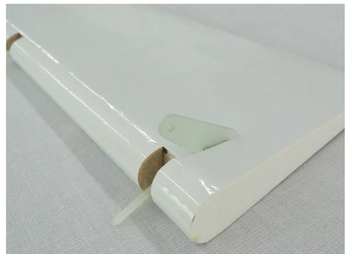
Bevor Sie nun Ruder mit Dämpfer verbinden, ölen Sie die 6 Scharniere ein um ein Verkleben zu verhindern. Nun können Sie die beiden Ruder mit dem Dämpfer verkleben, hier wieder PU Kleber verwenden
