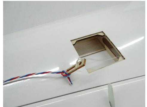
Im Flügel ist bereits ein Faden eingezogen, welcher Ihnen das einziehen des Servokabels deutlich erleichtert
