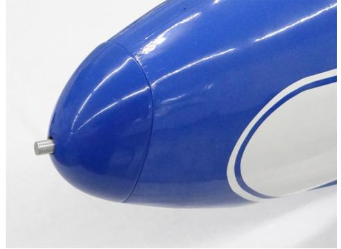
Der Propellermitnehmer wird einfach auf die hervorstehende Welle geklemmt und kann leicht wieder demontiert werden um die MG-19 auch als reinen Segler zu verwenden
