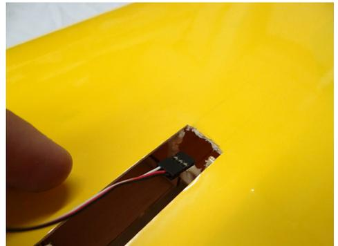
Nun können Sie die Störklappen in den Flügel kleben. Kontrollieren Sie vor dem Aushärten ob die beiliegenden Abdeckungen auf den Klappen passen und nicht überstehen
