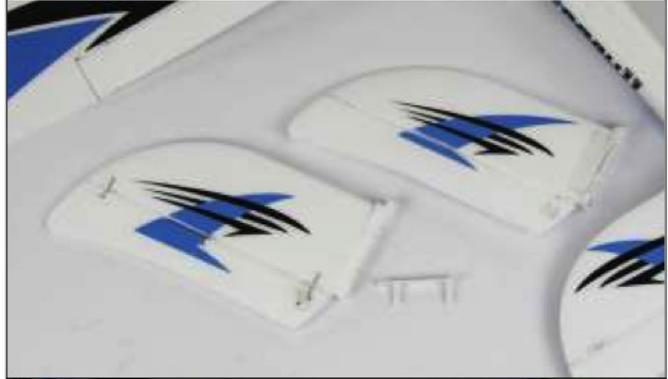
Verbinden Sie die beiden Hälften des V-Leitwerks.
