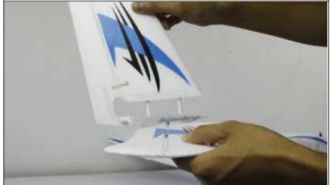
Verschrauben Sie das Seitenleitwerk mit dem Rumpf.
