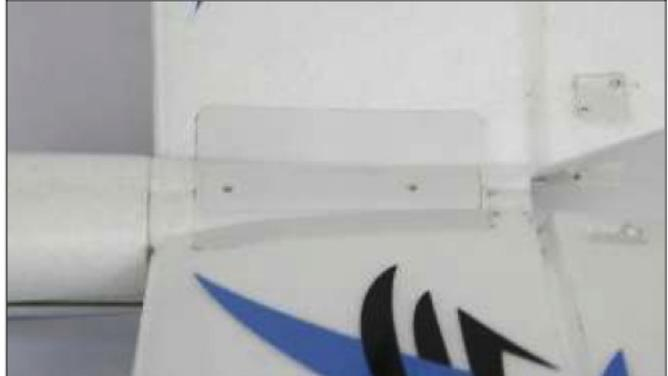
Verschrauben Sie das V-Leitwerk mit dem Rumpf.
