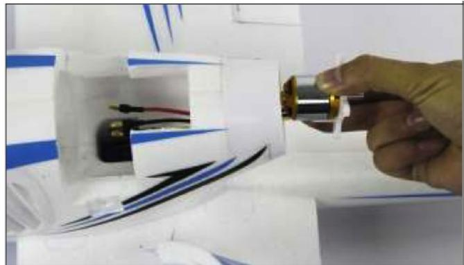
Verschrauben Sie die Motorbefestigung mit der Motorgondel.
