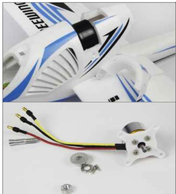
Installieren Sie den passenden Motor an der Motorbefestigung.
