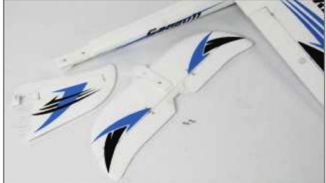
Setzen Sie das Höhenleitwerk auf dem Rumpf auf und schieben Sie das Seiten- in das Höhenleitwerk.
