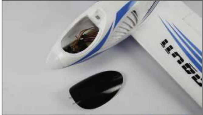
Schließen Sie die Servos an den Empfänger an und verbinden Sie einen geladenen Flugakku mit dem Empfänger. Zentrieren Sie alle Servos.
