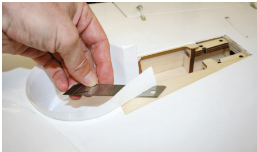
Die Verkleidungen der Radschächte werden mit etwas Übermaß verklebt und anschließend mit einer scharfen Klinge bündig abgeschnitten.
