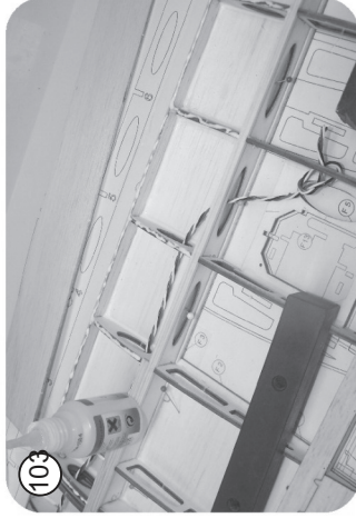
Obere Nasenbeplankung aufkleben, auf der Hilfsnasenleiste und den Rippen wird mit Weissleim, auf dem Holmgurt mit Sekunde. Mit Nadeln sichern.
