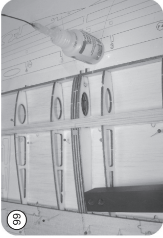
Untere Nasenbeplankung mit den Formkeilen an die Rippen anheben und an den Rippen und der Hilfsnasenleiste mit Sekundenkleber anheften
