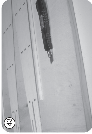
Leisten Balsa 4 x 4 mm auf Länge der hinteren Rumpfteile R 37 ablängen und an den Aussenkanten oben und unten bündig aufkleben, Leisten enden hinten in Spant R 47.
