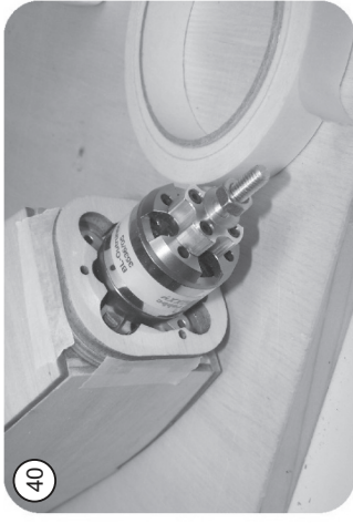
Antriebsmotor anschrauben, Baugruppe R 28 / R 29 aufstecken und mit Krepband sichern
