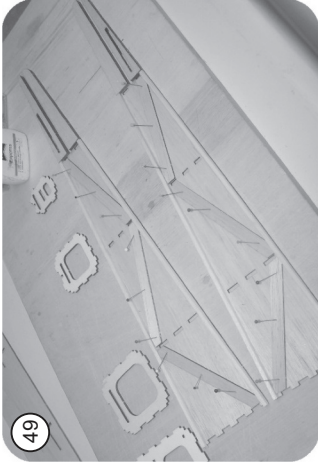
49 Bis zum Durchrocknen auf dem Baubrett aufgenadelt lassen
