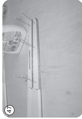
Verstärkungssteile R 41 und R 42 aufkleben, pro Seite je 2 Stck. Auf Deckungsgleichheit im Bereich der Höhenleitwerksausparung achten
