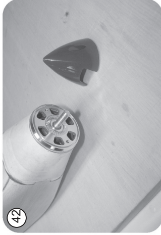
Abschluss-Spant R 36 mit Spinnerboden ausrichten und mit dem Rumpf verkleben. Gesamten Vorderrumpf verschleifen
