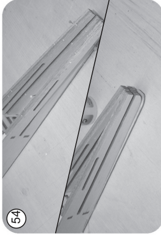
54 Rumpfenen gleichmäßig zusammen-drücken und mit Sekunde verkleben
