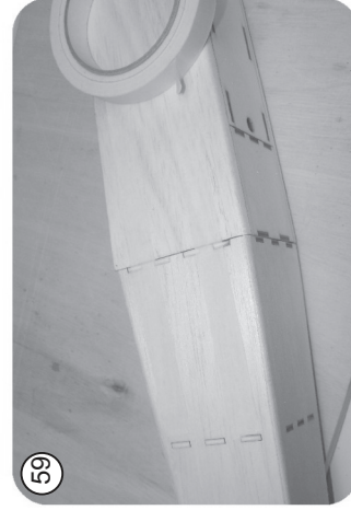
58 Verbindungsstelle von Rumpfvorderteil und Heck satt mit Weissleim einstreichen, Teile zusammenfügen und bis zum Durchrocknen mit Krepfstreifen verspannen
