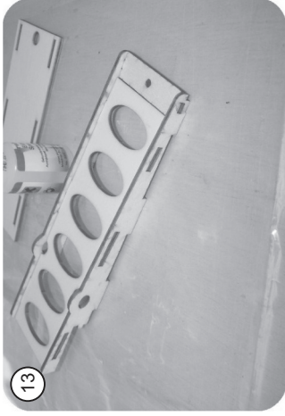
13 Akkuauflage R 25, Seitenteile R 26 und Distanzplatte R 27 zusammenstecken und verkleben
