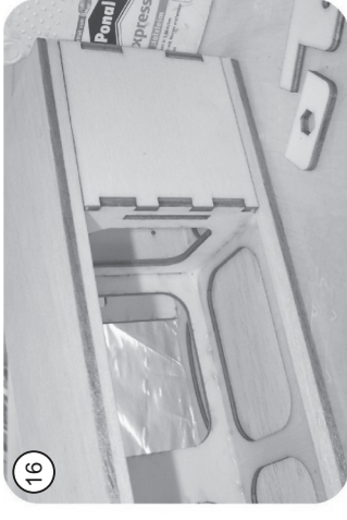
15 Rumpfboden hinten R 11 einkleben
