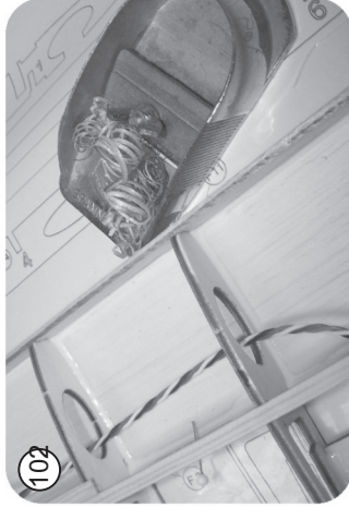
Hilfsnasenleiste F 7 an der Vorderkante passend zum Profilverlauf schräg hobeln
