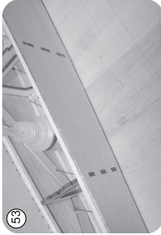
53 Seitenteile passgenau auf die Spanten drücken und von der Innenseite mit dünnem Sekundenkleber verkleben
