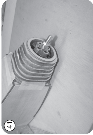
Ringspanten R 30 - R 35 ankleben, dabei mit dem Motor mittig ausrichten
