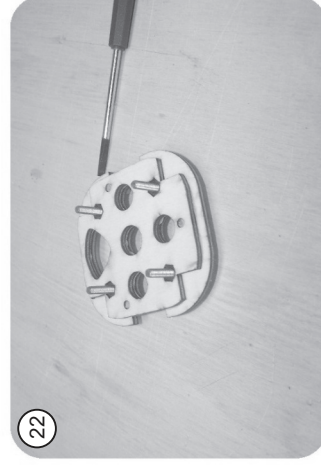
22 Gewindemutter M 3 mit entsprechenden Schrauben in den Spant R 12 einziehen und Abdeckplättchen R 14 aufkleben, Schrauben wieder herausdrehen.
