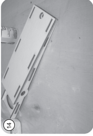
14 Baugruppe R 25, R 26 und R 27 in den Bodendeckel R 24 einkleben und bis zum Durchtrocknen mit Gewicht belegen
