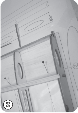
Untere Nasenbeplankung mit den Formkeilen an die Rippen anheben und an den Rippen und der Hilfsnasenleiste mit Sekundenkleber anheften
