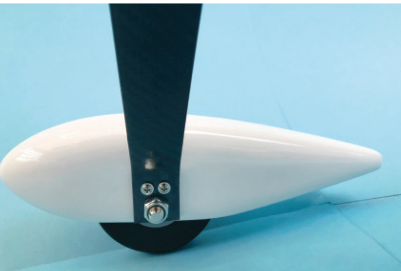
Die GFK-Radschuhe befestigt man mit zwei M3-Schrauben am CFK-Fahrwerksbügel.
