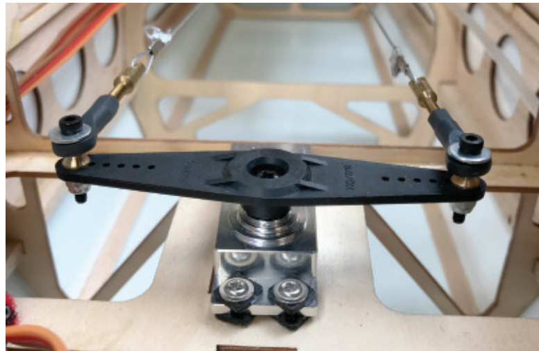
Die Seile des Seitenruders sind über Kreuz geführt. Als Servo kommt ein KST DS725MG zum Einsatz.
