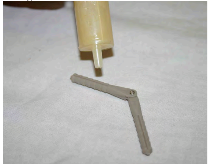
Abbildung 7: Stiftscharnier einkleben a)
