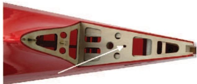
Abbildung 16: Seitenruder Sicherungsschraube Bohrung
