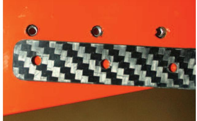
Abbildung 26: Heckfahrwerk Befestigung
