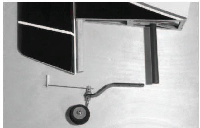
Abbildung 27: Heckfahrwerk
