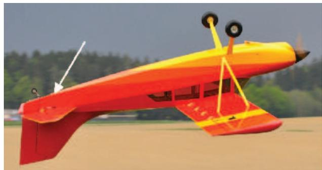
Abbildung 17: Seitenruder Sicherungsschraube Montagepunkt
