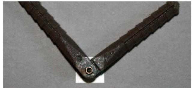
Abbildung 3: Querruderscharnier / Gelenkbereich ölen
