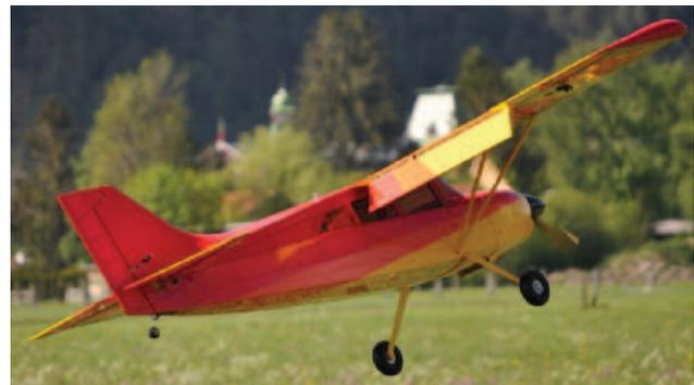
Abbildung 14: Landeklappen gesetzt
