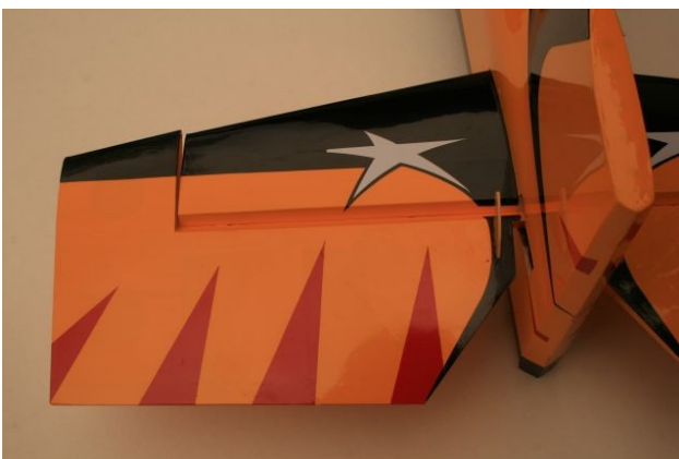
Abbildung 33: Höhenruder / Scharniere einkleben
