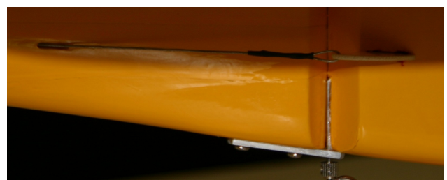
Abbildung 23: Symbolbild Seilanlenkung Sicherung mit Schrumpfschlauch
