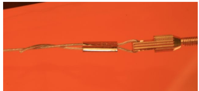
Abbildung 22: Symbolbild Seilanlenkung Sicherung mit Sekundenkleber
