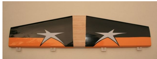
Abbildung 26: Höhenruder Scharniere einkleben
