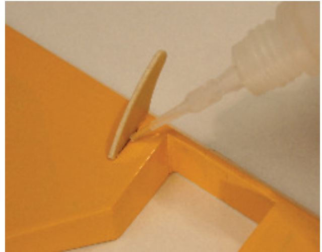
Abbildung 34: Höhenruder / Ruderhebel einkleben
