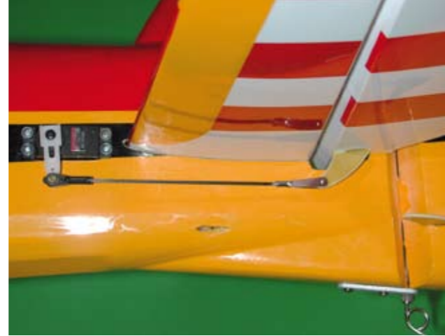
Wer einen 5s- oder 6s-LiPo bevorzugt, sollte das Höhenruderservo hinten einbauen. Der Servoausschnitt braucht dazu nur von der Folie befreit zu werden
