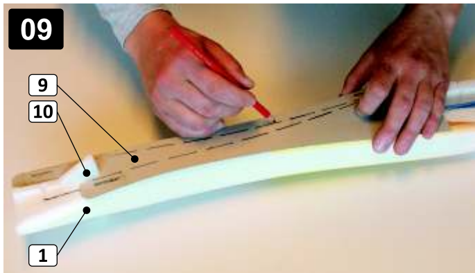
09 Na pravou stranu trupu přiložte šablonu (9). Tužkou vyznačte vedení lanovodu SOP (30). Vyměňte střední díl VOP (10) z trupu. Attach the template (9) to the right side of fuselage. Use a pencil to draw position of plastic tube (30). Take out former (10).
