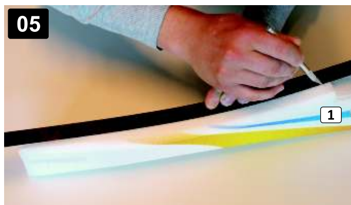
05 Prořízněte drážku pro výztuž (27). Hloubka 3mm. Cut the slot. The slot must be 3mm deep.
