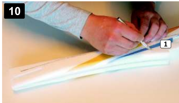
10 Na levé straně trupu prořízněte drážku pro vedení lanovodu VOP (31). Hloubka 6mm. Cut the slot for the tube (31) on the left side of fuselage. Slot must be 6mm deep.
