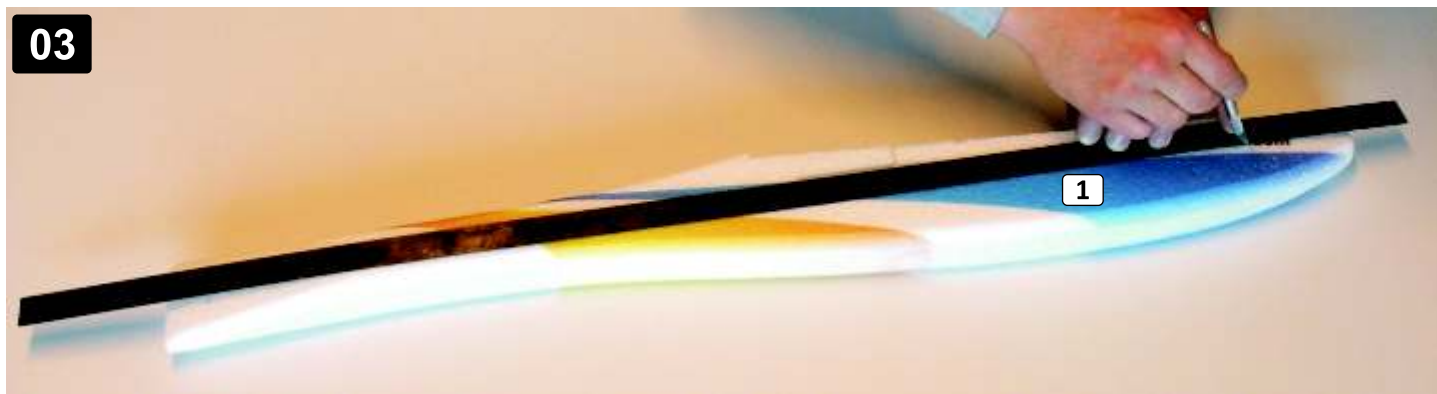
03 Podél pravítka prořízněte drážku pro výztuž (26). Hloubka 3mm. Řez provedte z obou stran trupu. Cut the slot along a ruler. Slot must be 3mm deep. Cut both sides of fuselage.
