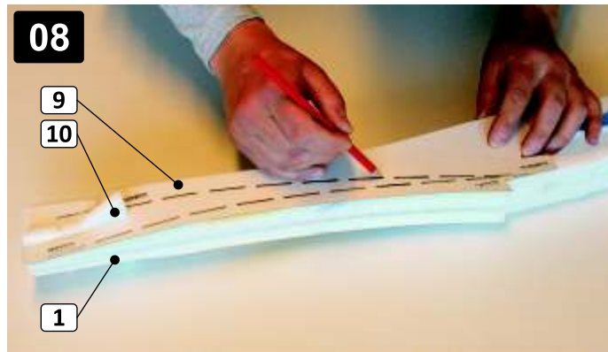
08 Do trupu (1) vložte střední díl VOP (10) a na levou stranu trupu přiložte šablonu (9). Tužkou vyznačte vedení lanovodu VOP (31). Insert middle part of elevator (10) to the fuselage (1). Attach the template (9) to the left side of fuselage. Use pencil to draw position of plastic tube (31).
