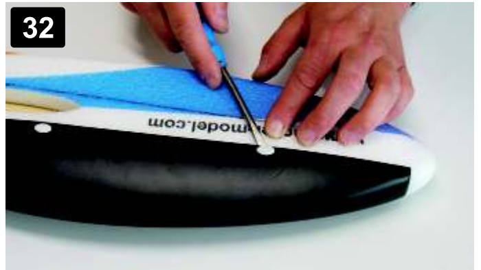
32 Sundejte kabinu (7) z trupu (1). Použijte šroubovák. Remove the canopy (7) of fuselage (1). Screwdriver can help you.
