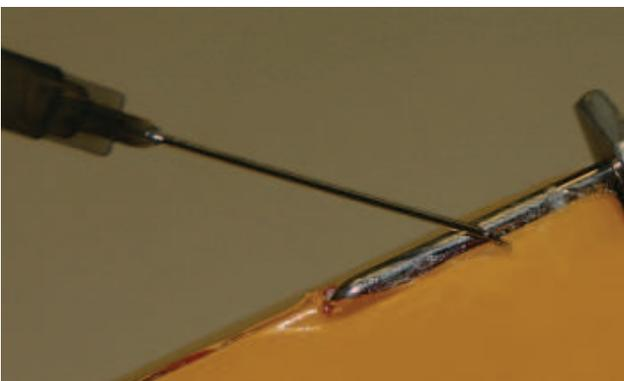
Abbildung 10: Heckfahrwerk / Verklebung
