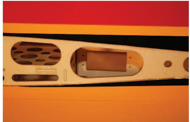
Abbildung 20: HR-Zentralservo / Orientierungshilfe / Wurzelrippe
