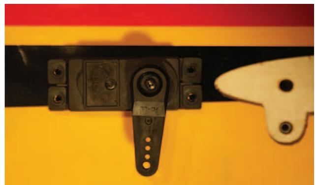
Abbildung 25: HR-Servo / Rumpfmontage
