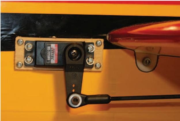
Abbildung 26: HR-Servo / Adapterrahmen
