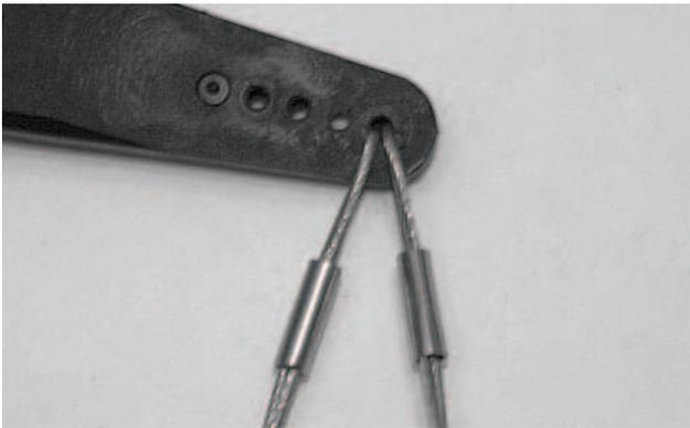
Abbildung 22: HR-Servohebel / Seilanlenkung
