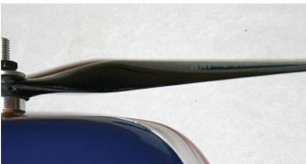
Abbildung 27: Distanz Motorhaube - Luftschraube
