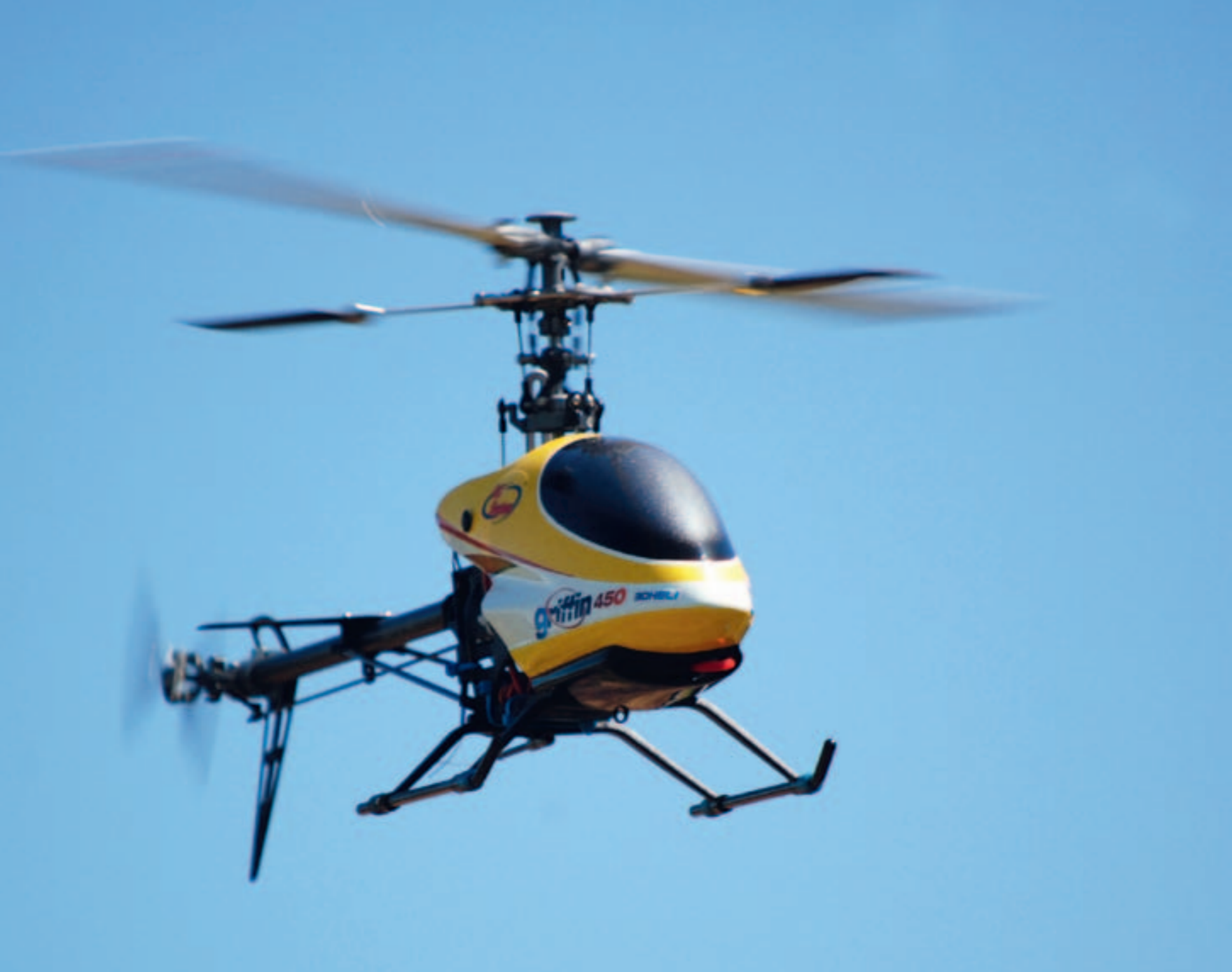
Der Grundaufbau basiert auf einem Chassis aus Kunststoff
